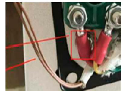
Cabos de contato de Termostato 130°
